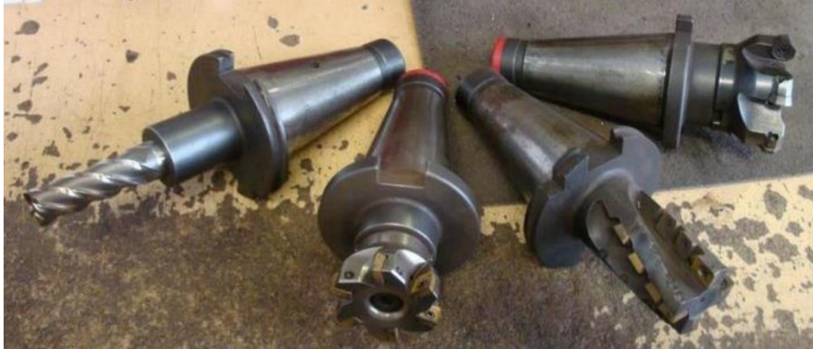
Obr. 47: Upínání fréz s kuželovou stopkou
