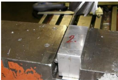
Obr. 77: Frézování plochy kolmé k základně
