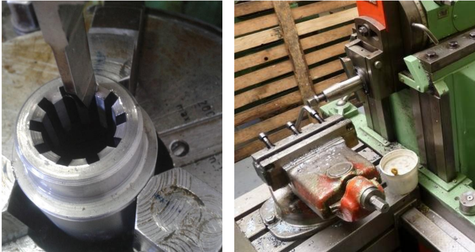
Obr. 114: Upínání obrobků při obrážení
