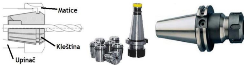
Obr. 53: Schéma kleštinového upínače, ISO 40 kleštinový upínač pro ruční výměnu nástroje, kleštinový upínač pro automatickou výměnu nástrojů
