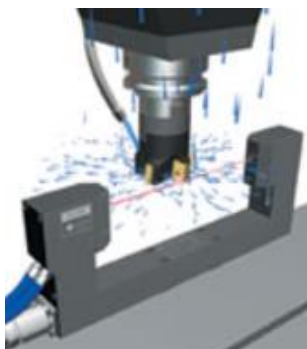
Obr. 82: Přesné laserové měření rozměrů a opotřebení nástrojů
