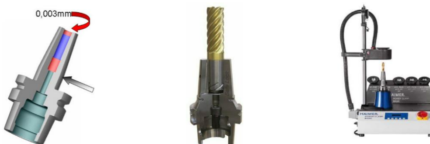
Obr. 64: Princip tepelného upínání
